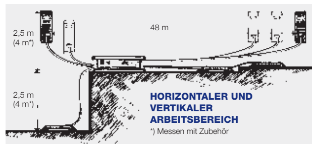
Taststangeneinsatz beim Nivellieren einer Deckenschalung (Einhand-Spindelverstellung)
